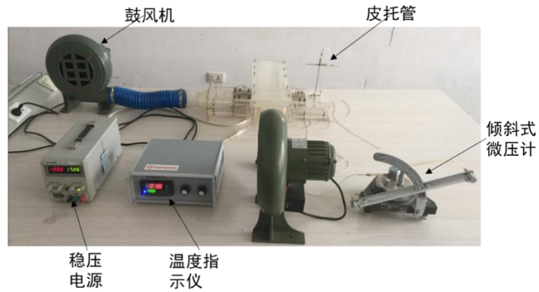
图 1 自行设计、研制的热工流体综合教学实验台
